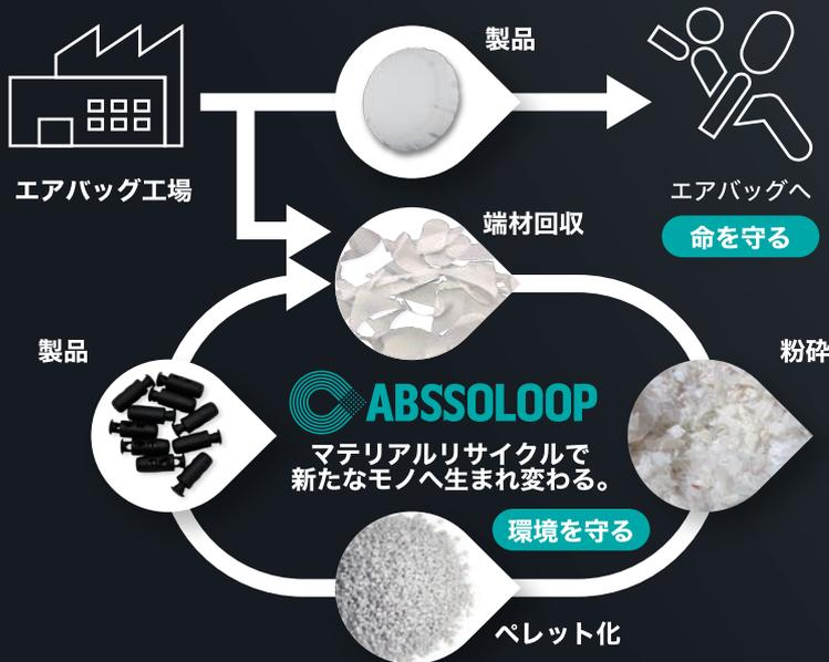
エアバッグの材料調達から製造まで関わる豊田通商は工場が発生する複合布の端材を回収し、リサイクルナイロン66として蘇らせる方法を開発しました。
